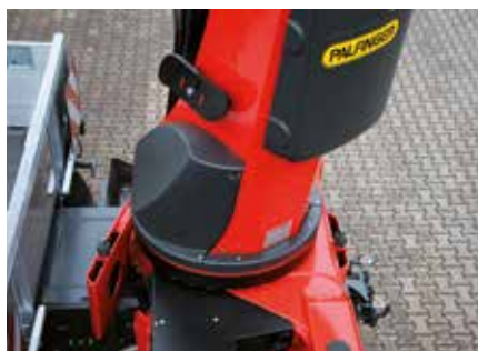
Sistema de rotación continua Movimiento sin restricciones
